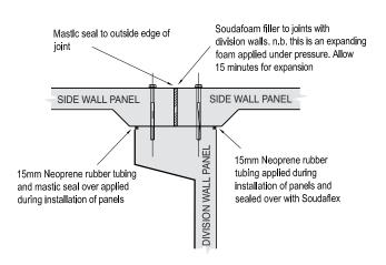
SECTIONAL PLAN AT DIVIDING/SIDE WALL **VERTICAL JOINTS**
